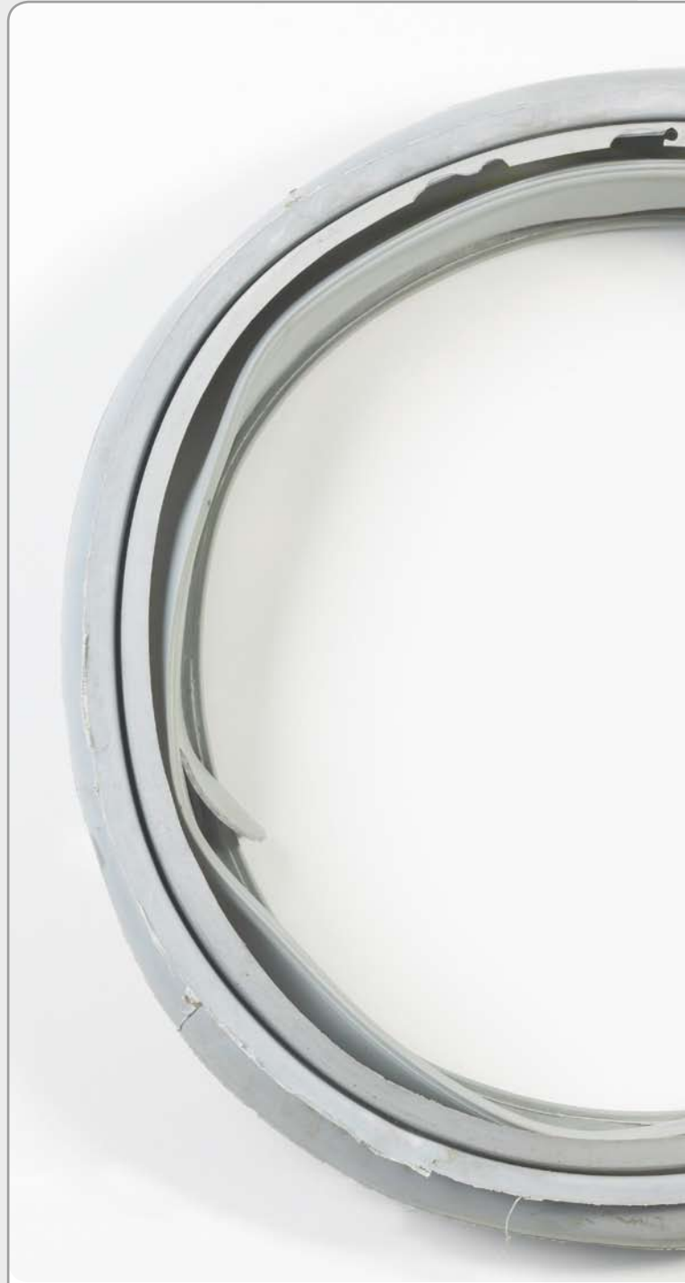
Abbildung_40: Defekte Gummidichtung
