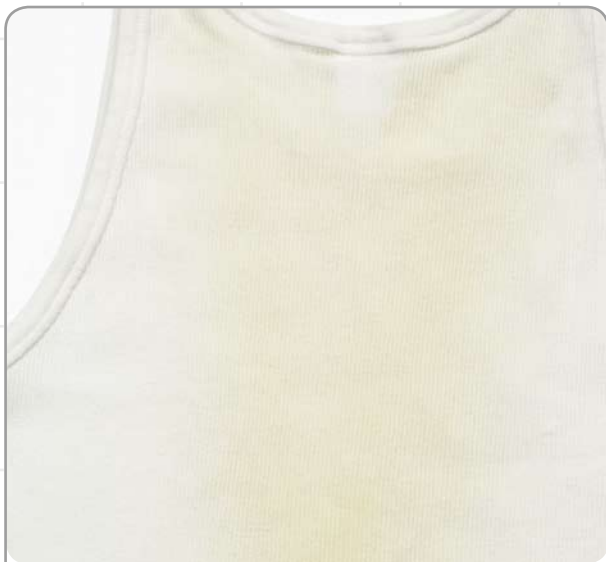
Abbildung_34: Partielle Manganvergilbung in einem Unterhemd
