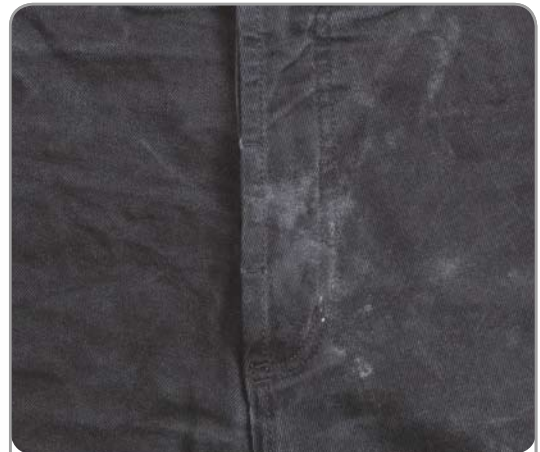
Abbildung_17: Waschmittelrückstände auf Textilien
