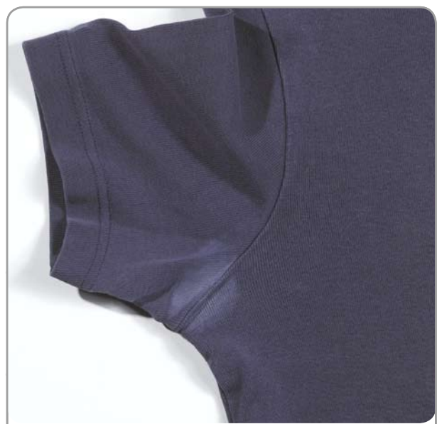
Abbildung_25: Chemischer Einfluss durch Körperschweiß in Verbindung mit Aluminiumsalz unter den Achseln
