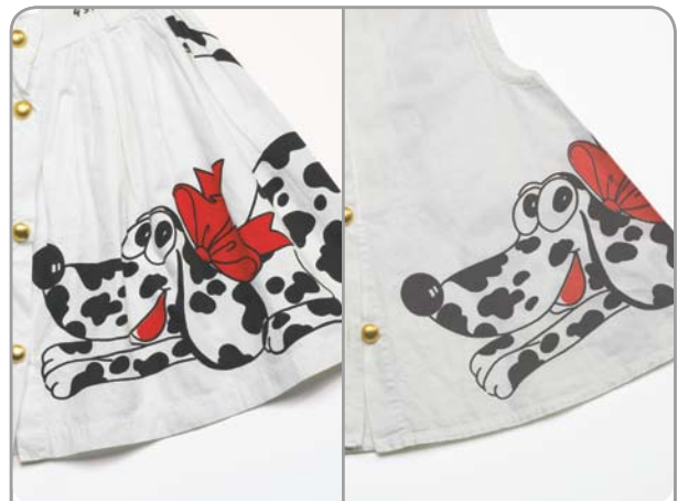
Abbildung_7: Abriebempfindliches Druckmotiv (links: Original)
