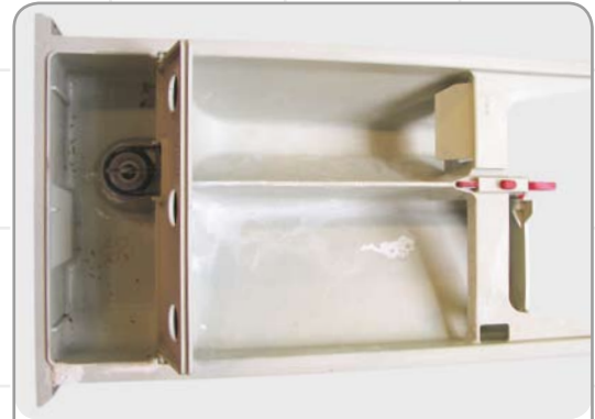
Abbildung_16: Einspülkammer mit Waschmittelresten
