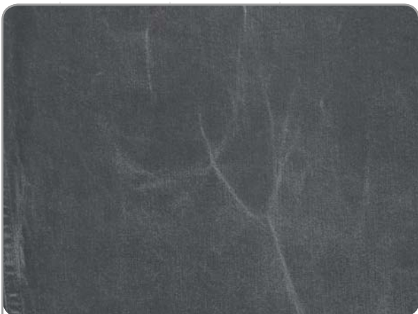
Abbildung_6: Blanchissuren in einem Jeansgewebe
