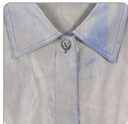
Abbildung_11: Farbschäden in Seidenbluse (dunkelblau = ursprünglicher Farbton)
