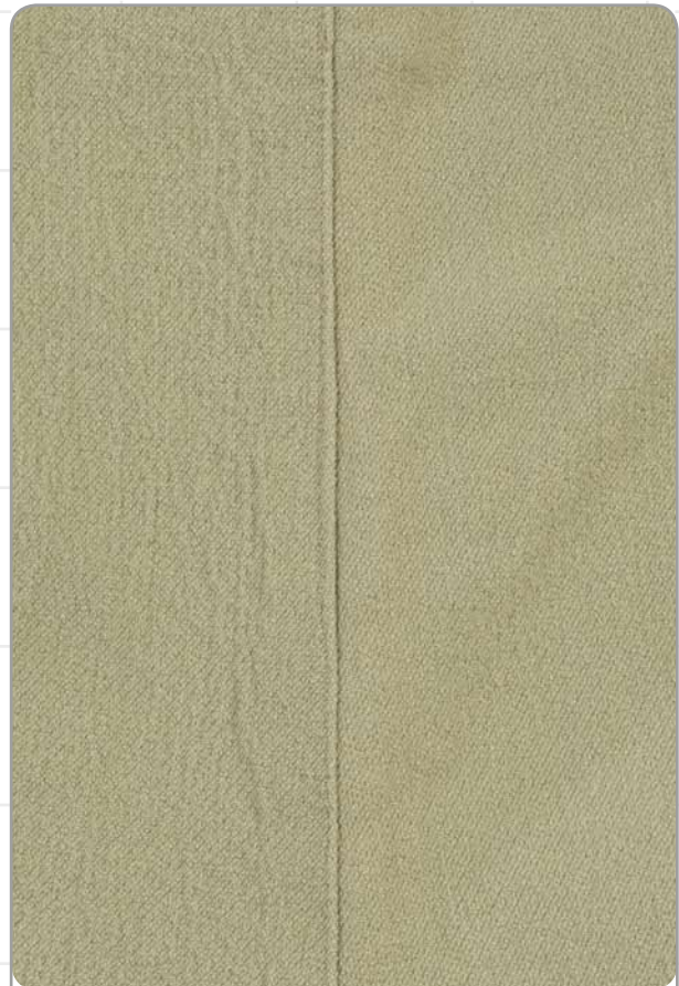
Abbildung_39: Warenfehler in Form von Strukturveränderungen im Gewebe
